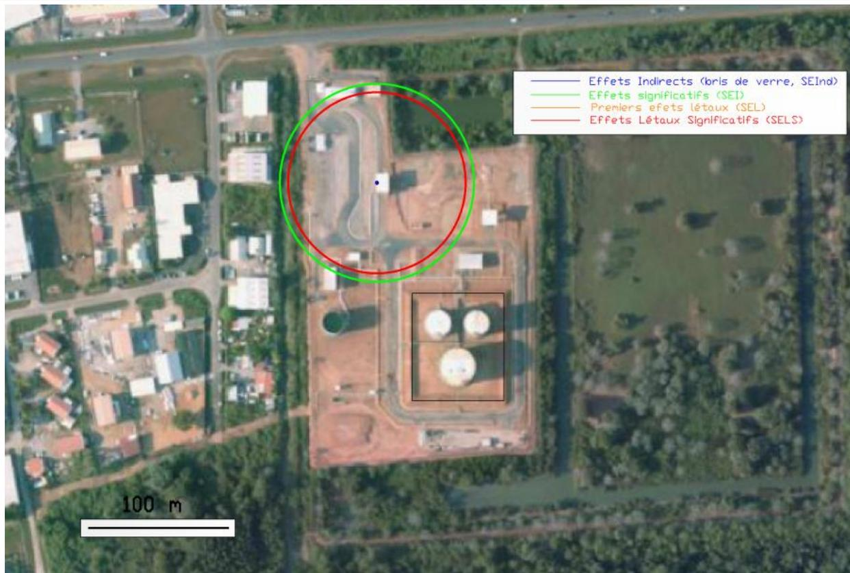
Cette représentation permet de déterminer la gravité associée à une fuite localisée au PPC. Elle serait identique à celle d'une fuite sur la canalisation d'expédition : niveau de gravité « Important » compte tenu de la présence potentielle de moins d'une personne en zone des effets létaux significatifs au niveau du Canal.
