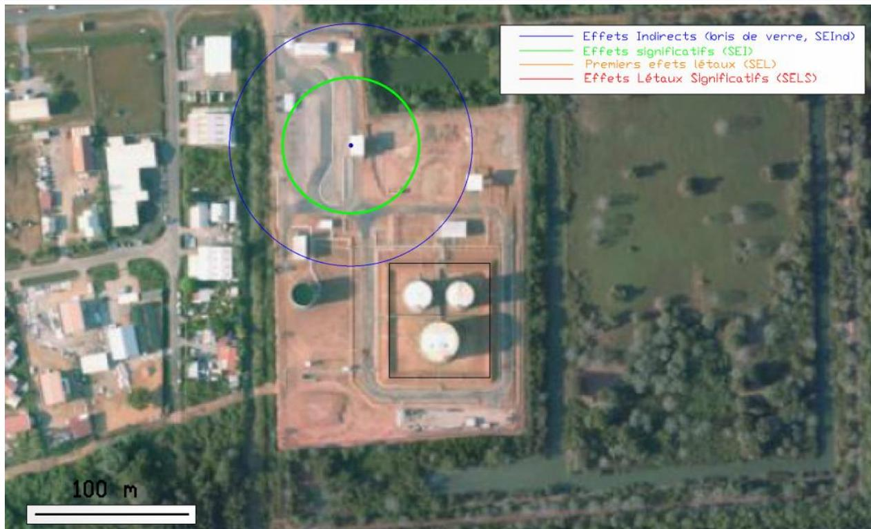
Cette représentation permet de déterminer la gravité associée à une fuite au PPC. Elle serait identique à celle d'une fuite sur la canalisation d'expédition : niveau de gravité modéré puisque seuls les effets indirects sortent des limites du site.
